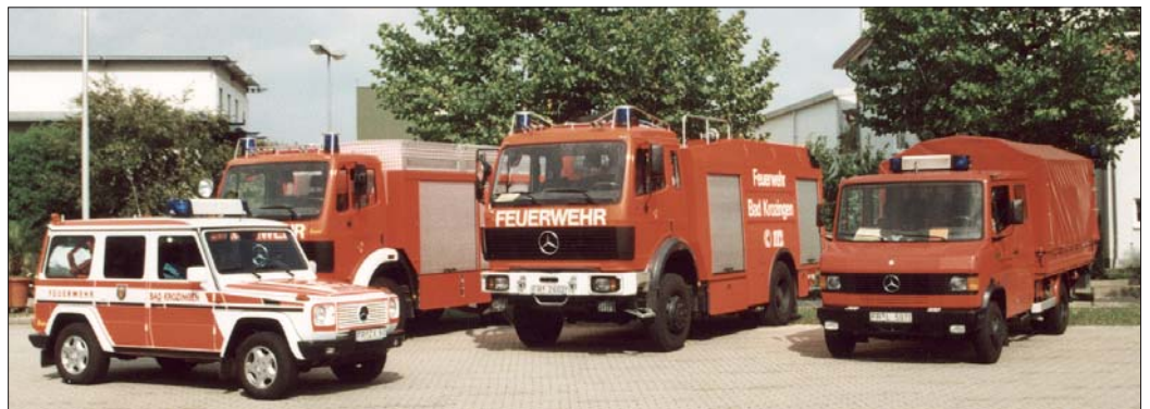
Rüstzug: Der Rüstzug der Krozinger Wehr besteht aus VRW, RW 2, TLF 24/50 und Lkw mit Verkehrssicherheitsanhänger (fehlt im Foto).
