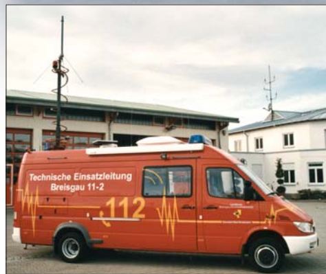
Konzept: Der ELW-TEL des Landkreises wird im Rahmen der Technischen Einsatzleitung eingesetzt. Drei identische Fahrzeuge – „Funken“, „Besprechung“, „Presse/Fachberater“ – hält der Kreis auf Mercedes-Sprinter mit Ausbau von Zikun vor.
