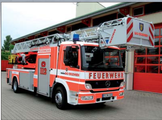
Neueste Anschaffung: Eine DLA-K 23-12 GL auf Mercedes-Atego 1528F mit S-Fahrerhaus (verlängert) und Automatikgetriebe im „Bad Krozinger-Design“.
